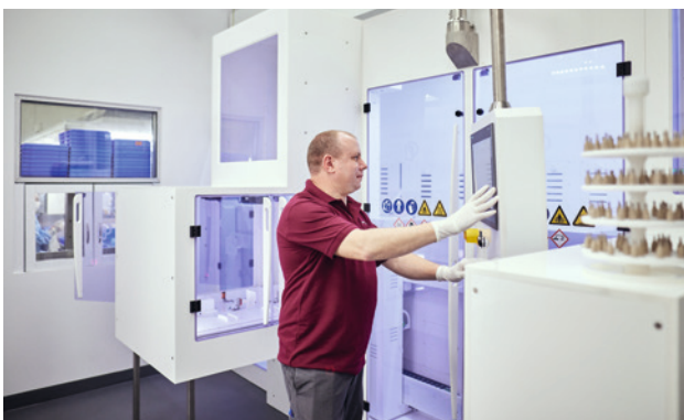
Die neue Ätz- und Reinigungsautomation der CPM Precision GmbH erweitert die Kapazitäten enorm und optimiert die Oberflächenbehandlung von Dentalimplantaten
